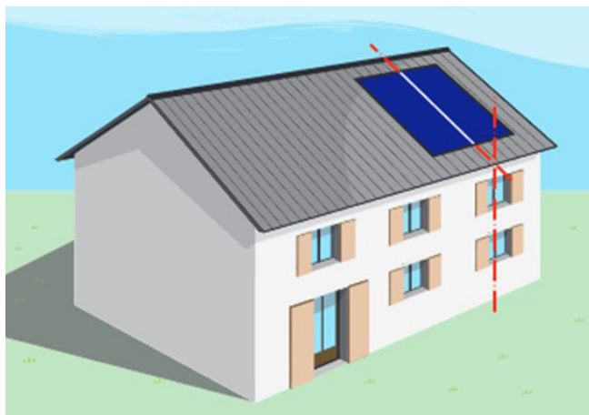
Placer les panneaux dans l'axe des fenêtres
