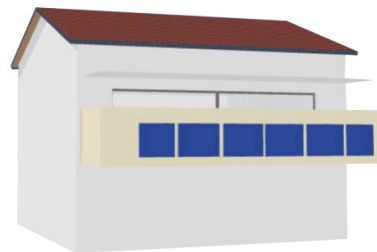
Intégration sur un garde-corps
